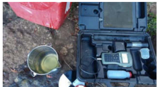
FOTO 16 – UTILIZAÇÃO DE SONDA MULTI-PARÂMETROS FONTE: ACQUAPLANT, 2021
