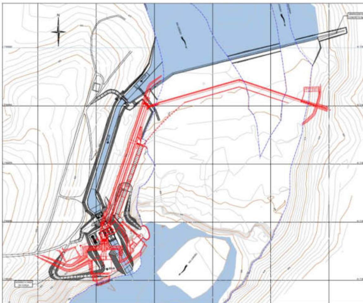
FIGURA 20 – COMPARATIVO PROJETO BÁSICO (2008 – COR VERMELHA) VERSUS PROJETO BÁSICO CONSOLIDADO (2021 – COR PRETA) DA PCH TRÊS CAPÕES NOVO.
